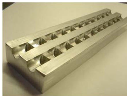
ABBILDUNG 6. Al 6061-T6 MESSPROBE.
